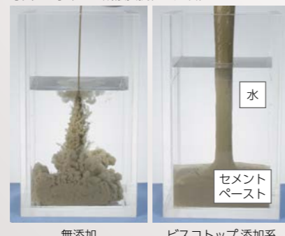
写真2 水中での飛散抵抗性と充填性
