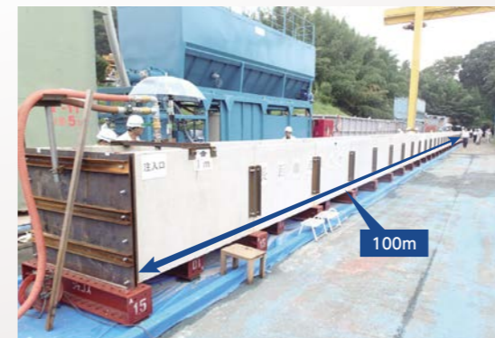
写真3 長距離水中流動実験の様子
