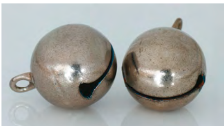
一枚の金属板をプレスで切り抜き、それを曲げて作られる鈴。溶接は一切使わない。金型を工程別に17、18種類作って仕上げる技術は、特許はすでに切れているが、いまもって世界中でマネができない。
