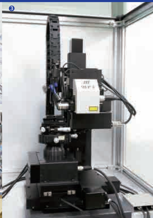
①イメージを伝えるために描かれた漫画 ②頭上から顕微鏡が下りてくる「手術用顕微鏡」 ③④オートフォーカスで1ナノレベルまで測定できる「非接触型三次元形状測定装置」 ⑤地上に設置されている2,680枚のミラーで太陽光を集光・高熱変換・蓄熱する「ビームダウン式太陽熱集光装置」
