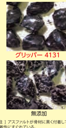
写真1 静的はく離試験結果
