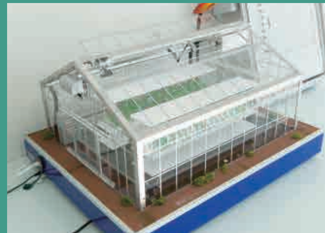
栽培環境を制御する植物工場の模型。日照や温度、湿度などを感知するセンサーと連動した、天窓やひよけなどの機器類の操作を自動制御している
