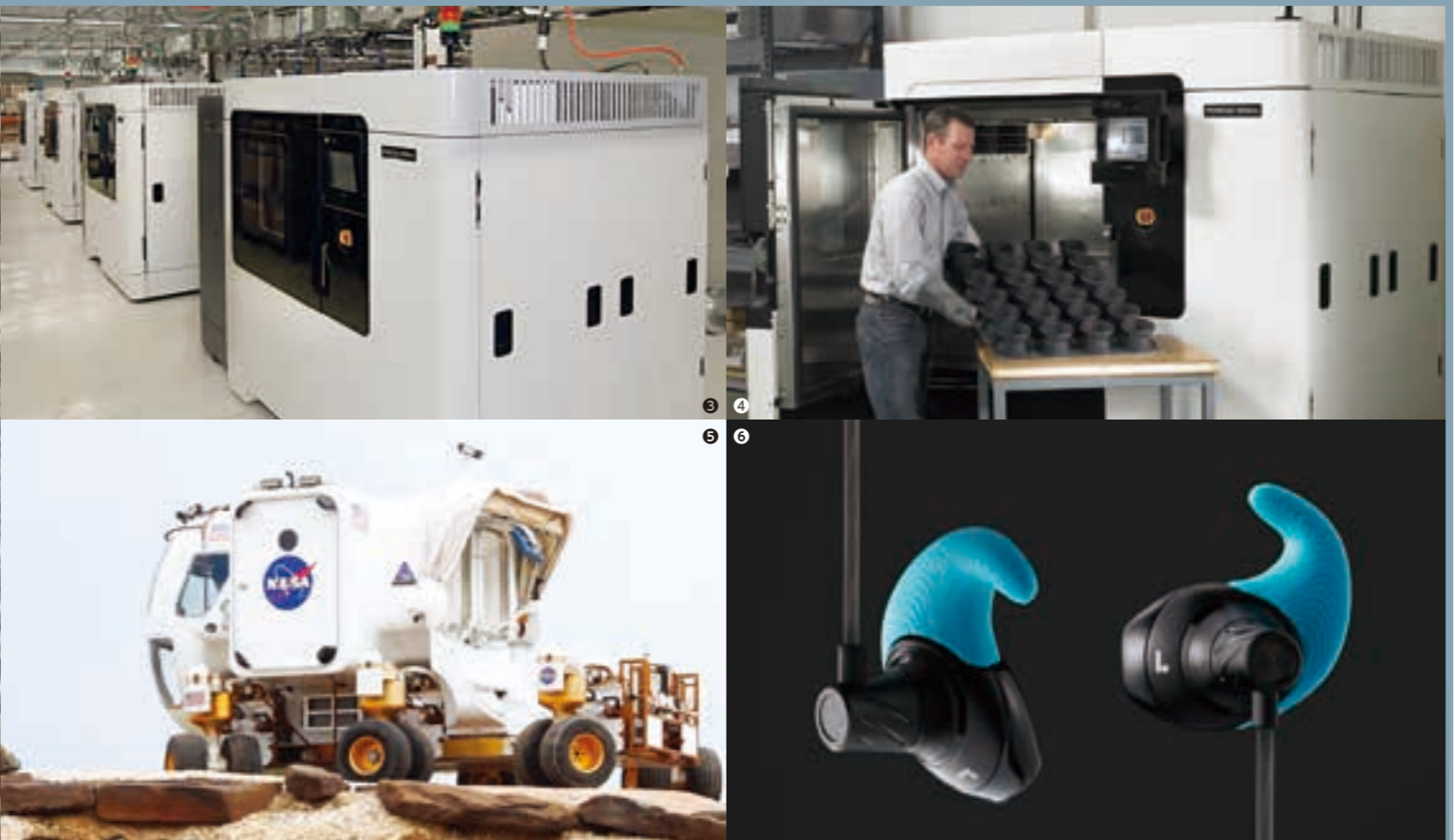
①ストラタシス社の3Dプリンタで作製されたパーツ。マスカスタマイゼーションや短期での出荷も可能になる。②ストラタシス製の3Dプリンタ本体。③DDM方式の採用で部品を一度に大量に作れるようになった。④部品はデータから直接作成することができる。⑤NASAの探査機にも3Dプリンタで造形した部品が使用されている。⑥カスタムオーダーのイヤフォン。自分の耳にフィットする形状をオンラインからも注文できる。
