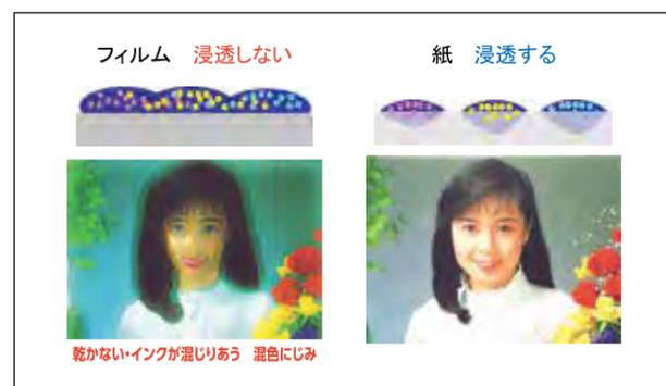
インクの乾燥性を高めるアプローチはさまざまありますが、フィルム基材に対するインク量が多すぎる点に着目し、インク使用量を極限まで減らすことを試みた結果、インクの乾燥性は飛躍的に向上し、混色にじみが大幅に改善しました。しかし、フィルム基材に着弾したインクのドット径が設計レベルまで広がらないために、低濃度化や筋の発生などの画質低下が新たな課題となりました。
