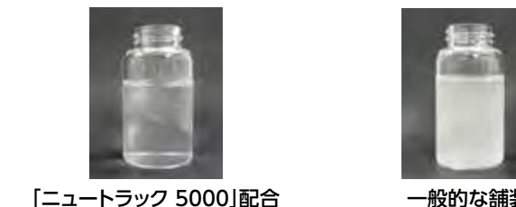
図3 走行試験後のマイクロプラスチック抑制状況
